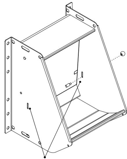
Bei Installation Metallstück auf gewünschter Seite mit Zange ausbrechen und Riegelbolzen mit Kugelknopf verschrauben. Zum Verschieben leicht lösen.
